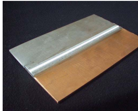
Przykład zgrzewanych liniowo na zakładkę blach Cu+Al (g = 4.0 mm)
