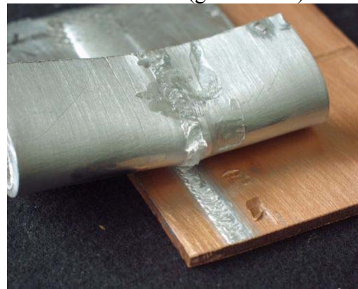
Wyłuskanie blachy Al (g = 4.0 mm) zgrzanej liniowo na zakładkę z blachą Cu (g = 4.0 mm)
