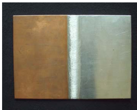
Przykład zgrzewanych doczołowo blach Cu+Al.
